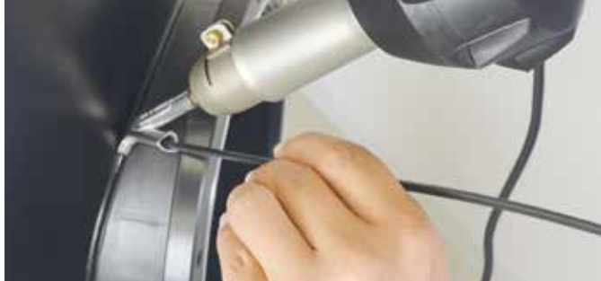
Svařování pomocí rychlosvařovací trysky
