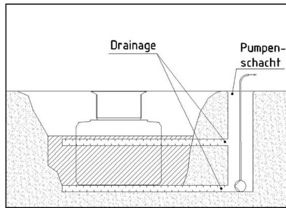
Zpravidla stačí zakrytí nádrží zeminou, aby se předešlo jejich vyplavení. Zakrytí zeminou, které je zapotřebí pro zajištění proti vztlaku, se dosáhne zpravidla tehdy, když je nádrž zeminou (hustota > 1800 kg/m<sup>3</sup>) zakryta až k horní hraně dómu.
