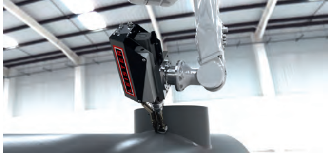
WELDPLAST 200-i / 600-i – robotické extruzní svařování a 3D tisk pro automatické operace
