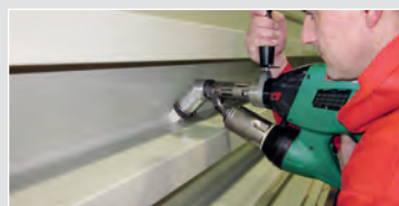
Úhlový adaptér 45° pro WELDPLAST S2 usnadňuje svařování v těžko dostupných místech.
