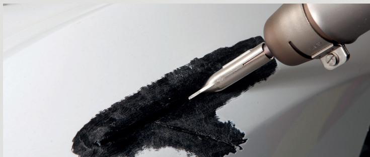
Svařování pomocí stehovací trysky (106.996) umožňuje vyrovnání zborcených částí před začátkem hlavního svařování.
