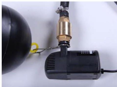
Obrázek č. 5: Připevněte plovoucí kouli k výtlaku pomocí nerezových háků
