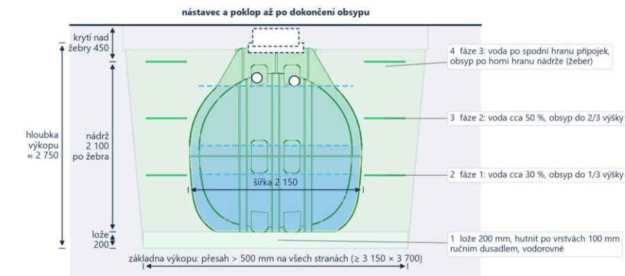
Obr. 2 – Lože a obsyp: plnění vodou a obsyp ve třech fázích, nástavec a poklop až po obsypu (schéma DESTO-7000-02, panel 4; postup v kap. 6.4).
