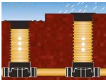
Kopírování povrchu se změnou počasí – přenos zatížení vyplývající z pohybů půdy při různém počasí a teplotě
